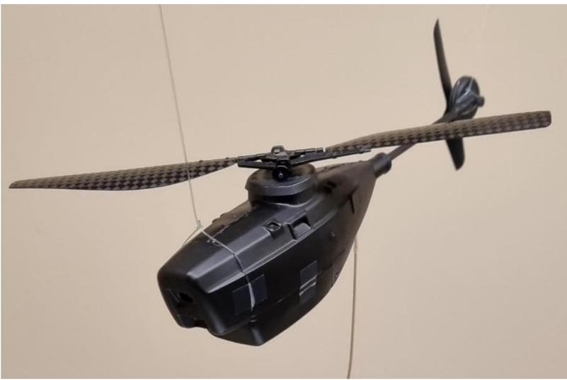
Le nano-drone Black Hornet 2, prêté par le 13<sup>e</sup> RDP, se lance entre deux doigts et tient une demi-heure en l'air pour fournir des images en haute définition grâce à une liaison protégée contre le brouillage.
